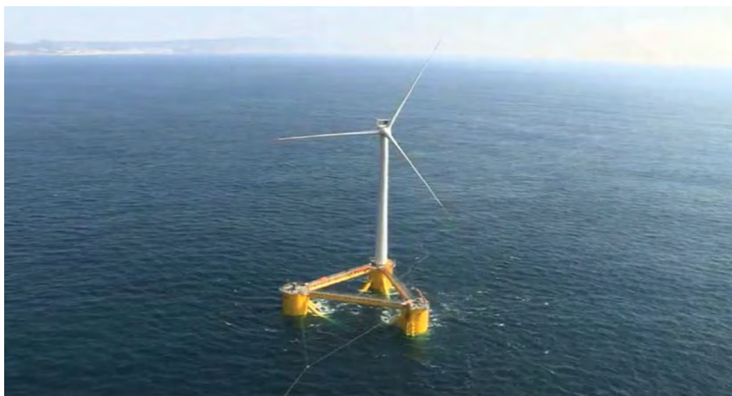
Plate 3.3. WindFloat Agucadoura, offshore Portugal.
