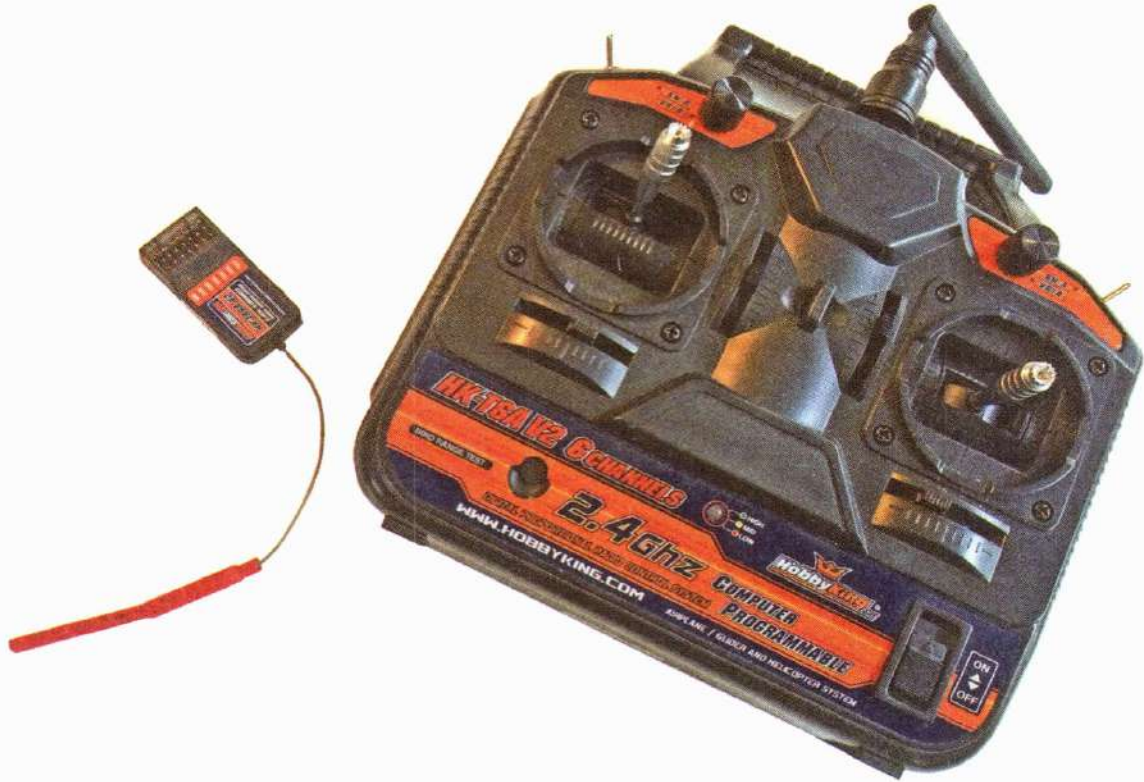
الشكل 7-8 المستقبِل HobbyKing الذي استخدمته في هذا الكتاب نموذجي نوعاً ما لمستقبِل سداسي القنوات.
