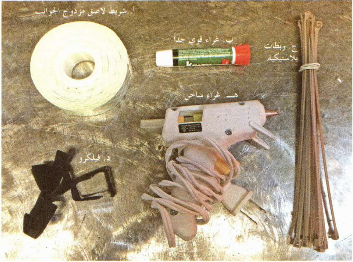
الشكل 9-6 هل تحتاج إلى توصيل شيء والبراعي لا تنفع؟ قد يكون الحل استخدام إحدى هذه الأدوات.
