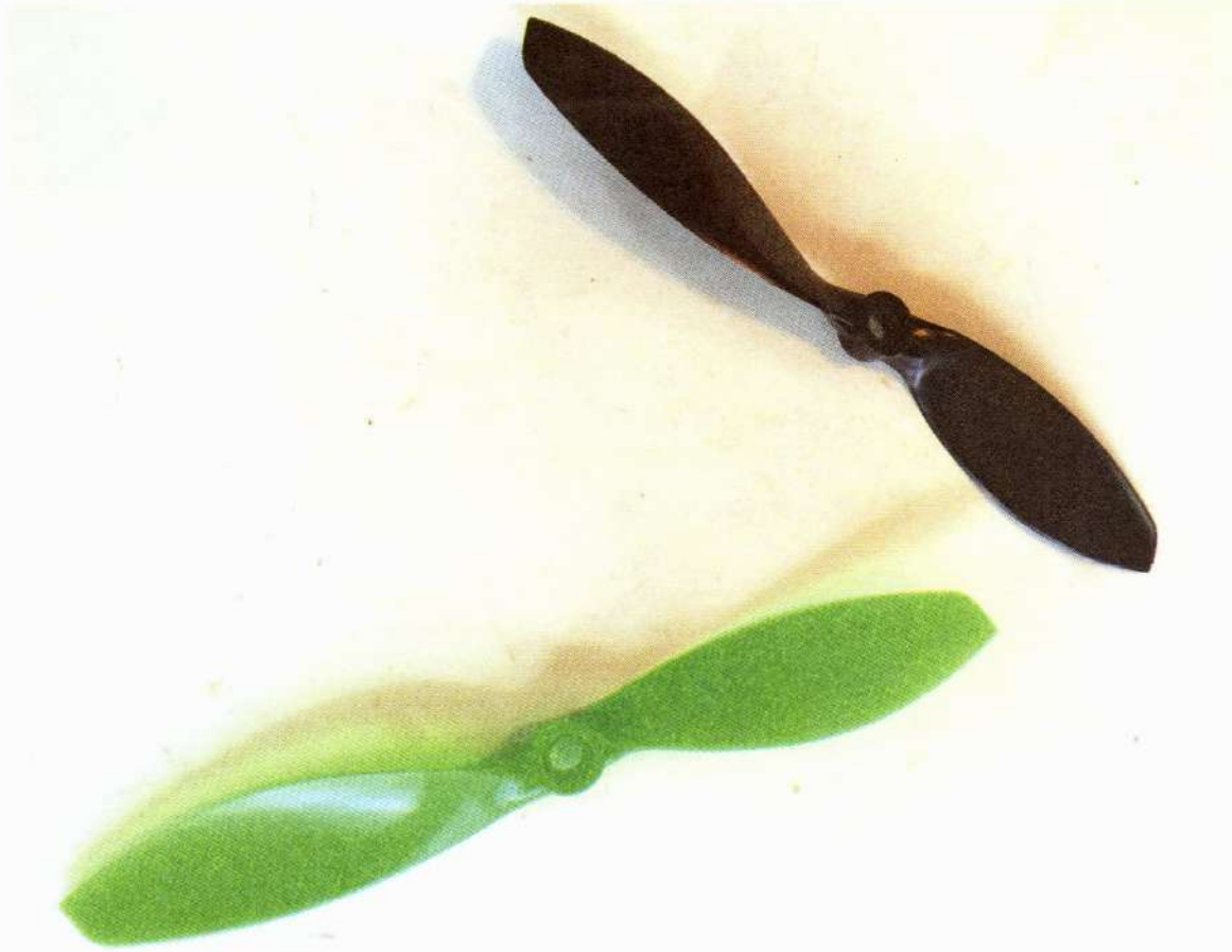
الشكل 5-6 تُصنَع المراوح الاعتيادية والدافعة بحيث تدور عكس بعضها البعض.
