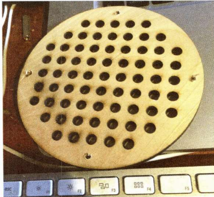
الشكل 12-17 ستحمي الصفيحة المقصودة بالليزر الجزء العلوي للكوادكوبتر.
