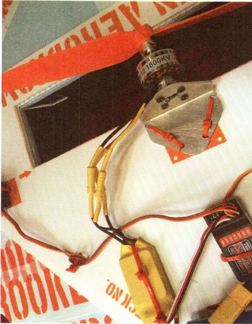
الشكل 4-6 محرك يعمل بالتيار المتناوب مع متحكم السرعة المطابق له.
