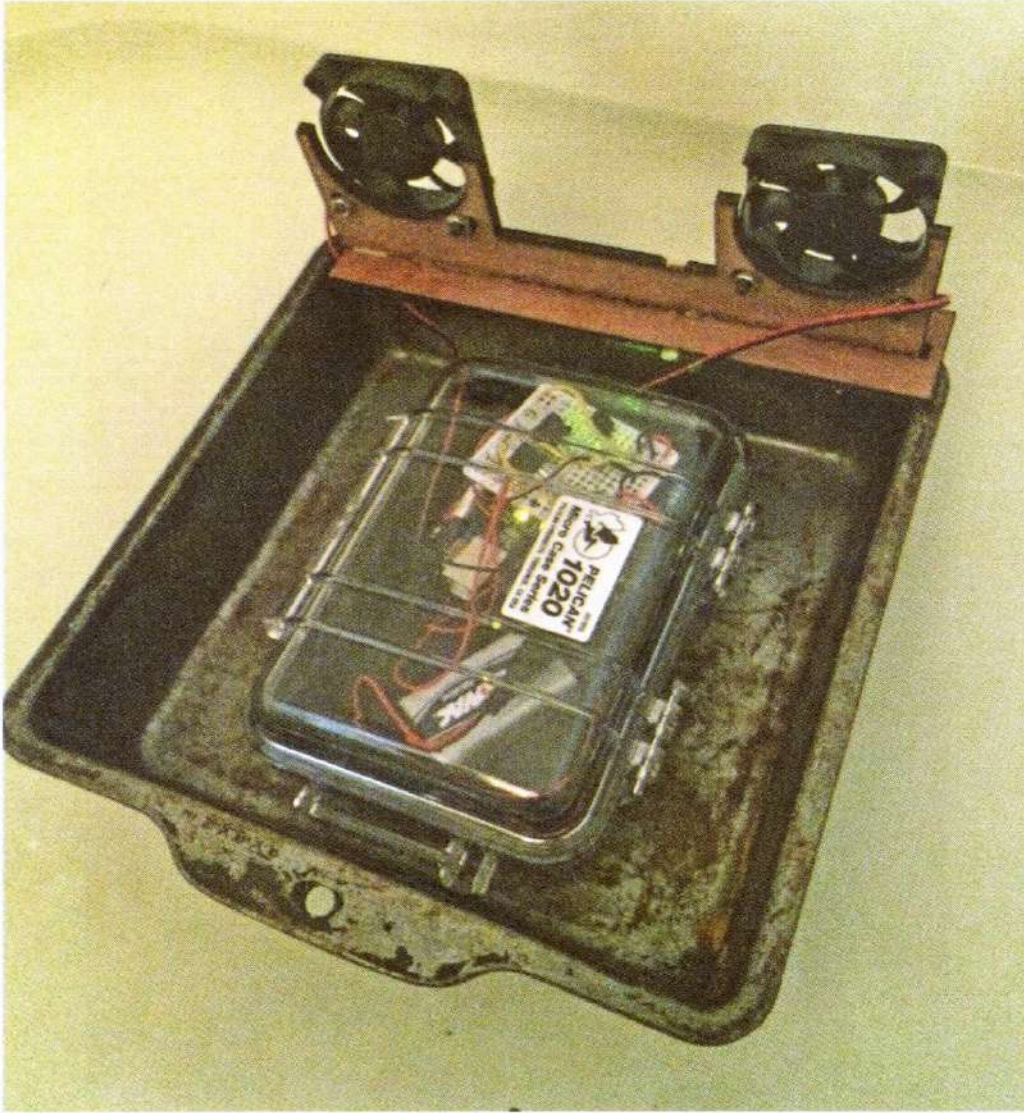
الشكل 2-11 يمكنك تحويل أي شيء إلى زورق، بما في ذلك صينية خبز الحلوى هذه.
