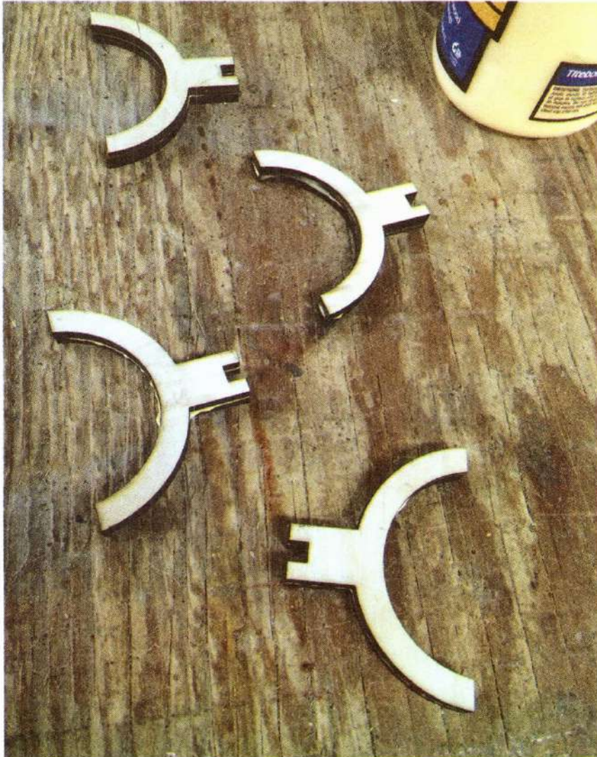
الشكل 8-11 يتضمن تصميم الهيكل مساند الزجاجات هذه.
