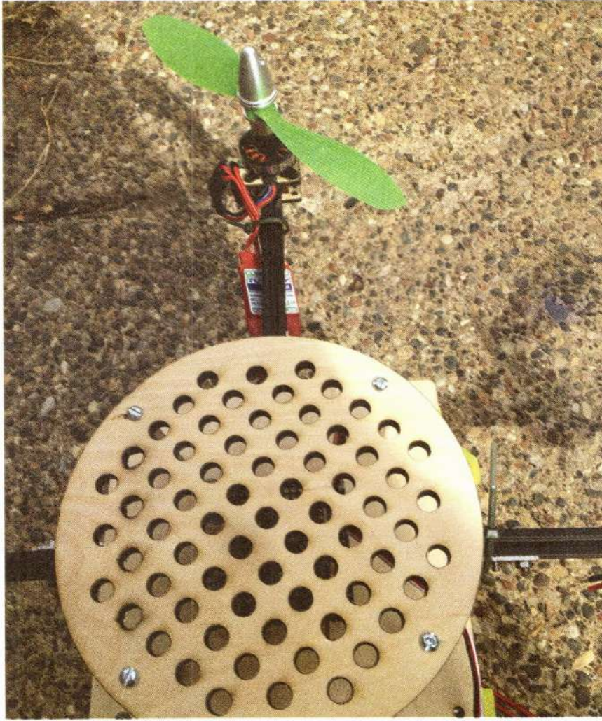
الشكل 12-16 الصفيحة العليا للكوادكوبتر هي آخر مكّون سنضيفه.
