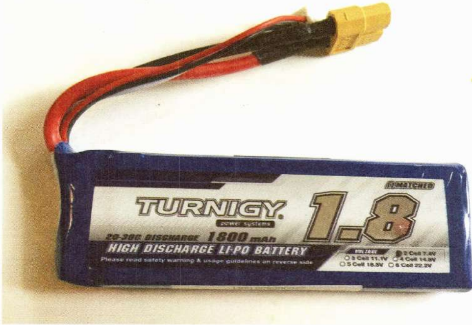
الشكل 10-3 البطاريات LiPo هي حل الطاقة المعتمد لمعظم الطائرات بدون طيار.
