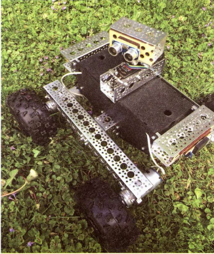
الشكل 9-13 تستخدم العربة الجوالة المتنقلة بتقنية التعرف بترددات الراديو مستشعراً فوق صوتي لقياس المسافات.
