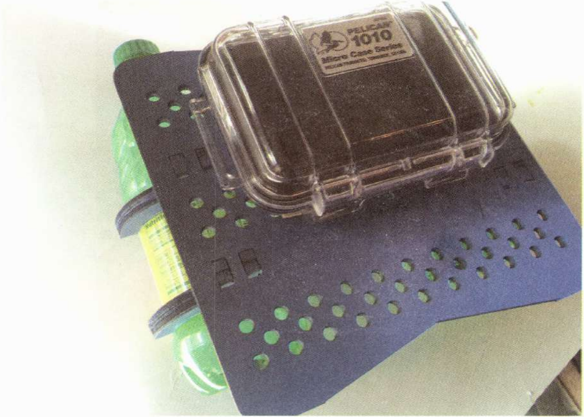
الشكل 10-11 وُصِّل علبة Pelican بالهيكل.
