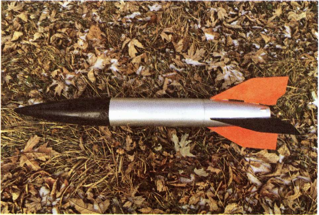
الشكل 5-11 يسجل صاروخ تجميع البيانات قياساته عن بُعد لدراستها لاحقاً.
