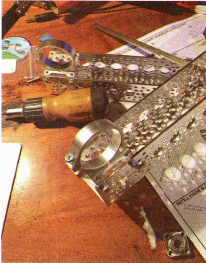
الشكل 13-13 وصال حاملات المحركات بالقنوات البالغ طولها 30 سم.
