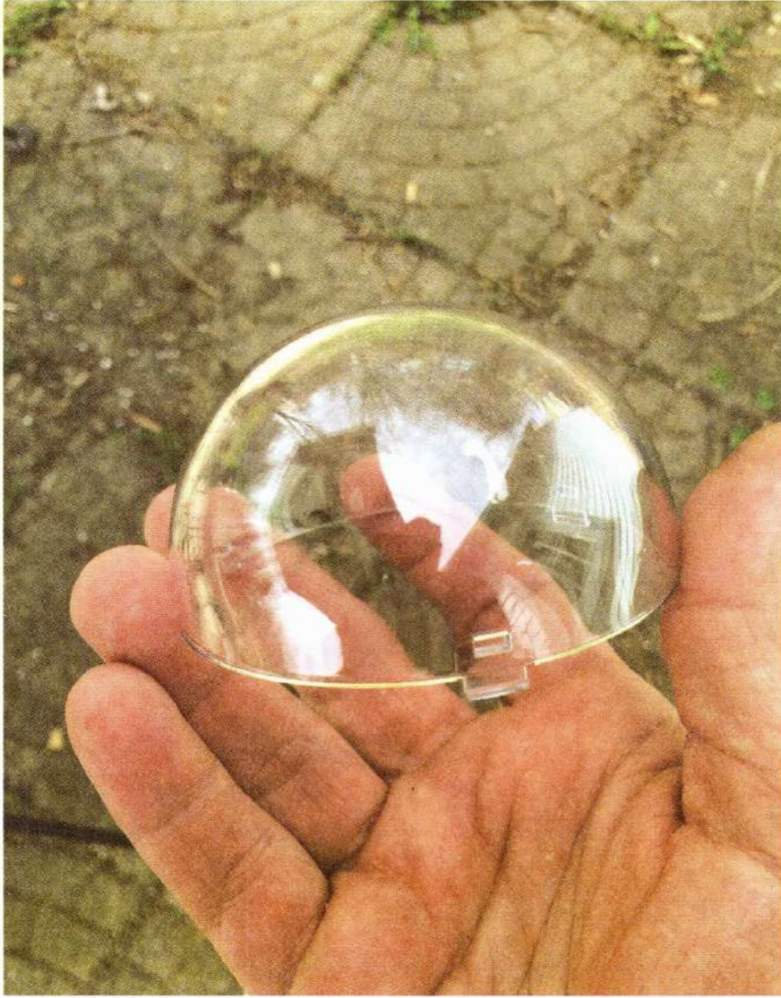
الشكل 6-12 تستطيع القبة الوقائية أن تحمي حزمة إلكترونياتك من الإصابة.
