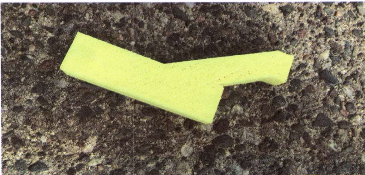
الشكل 12-14 تتألف معدات الهبوط من أربع من هذه القوائم.
