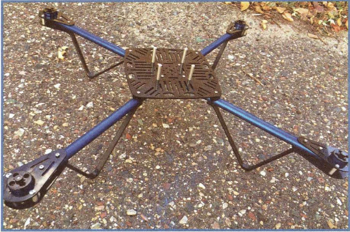
الشكل 2-4 تستخدم بارالاكس ELEV-8 هيكلًا خفيف الوزن مصنوعاً من البلاستيك والألومنيوم.
