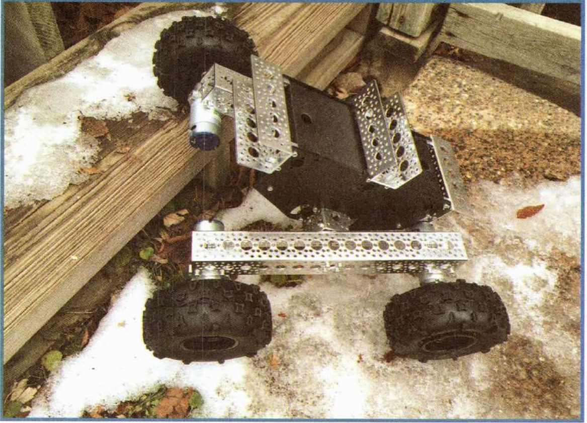
الشكل 12-3 العجلات ذات النتوءات مفيدة جداً عند اجتياز تضاريس وعرة.
