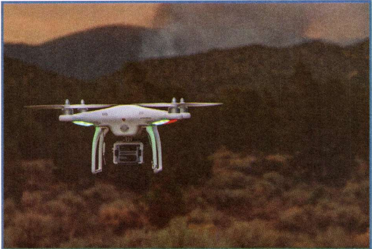
الشكل 3-6 أضواء الفانتوم المتميزة لا تنير الكوادكوبتر فقط، بل تبين للمشغل اتجاه المقدمة أيضاً.
