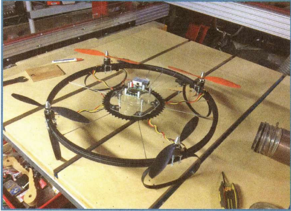
الشكل 2-1 استفاد سام لي من مادة لديه ليصنع هيكل طائرته الكوادكوبتر.
