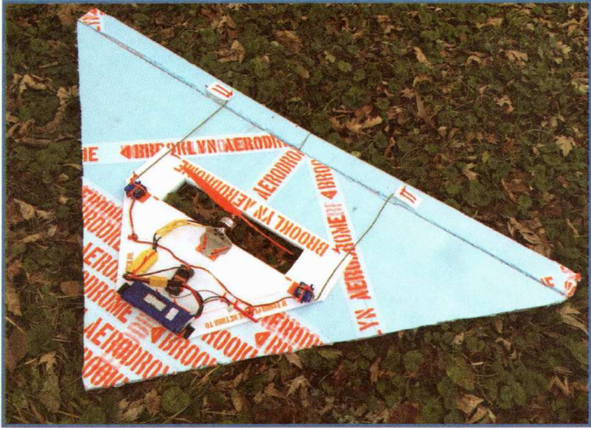
الشكل 3-13 Brooklyn Aerodrome Flack هي طائرة رخيصة ذات تحكم لاسلكي يستطيع أي شخص بناءها.
