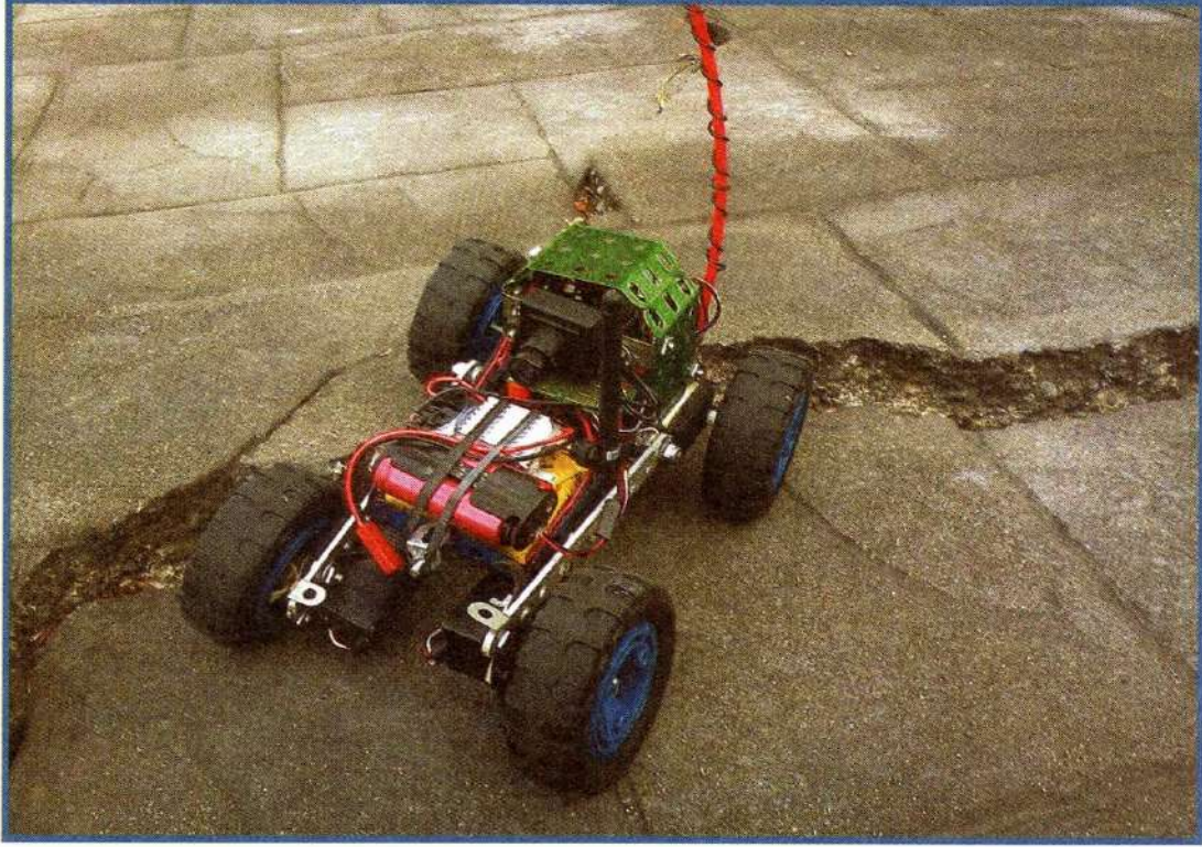
الشكل 1-4 هذه العربة الجوالة التي تحمل كاميرا تستخدم عجلات ذات نتوءات للتضاريس الوعرة.
