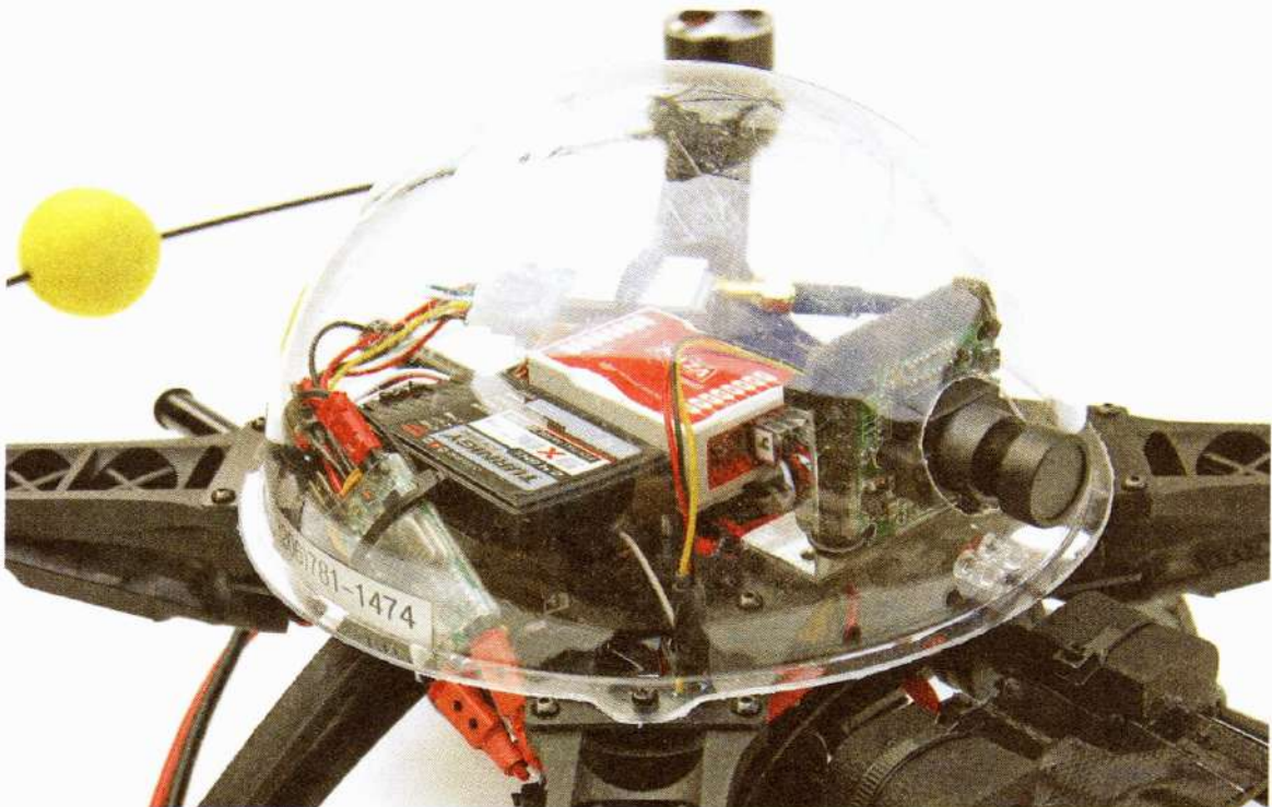
الشكل 3-12 تخرج عدسة التصوير الفيديوي عن بُعد في هذه الكوادكوبتر عبر القبة الواقية البلاستيكية.
