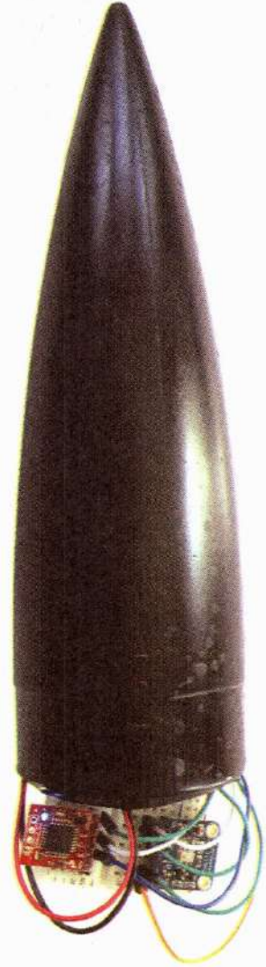
الشكل 5-18 أضاف الحمولة إلى الصاروخ. الشكل 5-19 مَدَّ الأردوينو الطاقة لكي يبدأ تسجيل البيانات.
