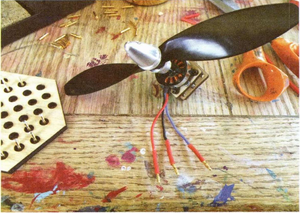
الشكل 4-10 الموصلات المخروطية هي طريقة التوصيل المفضلة في عالم التحكم اللاسلكي.
