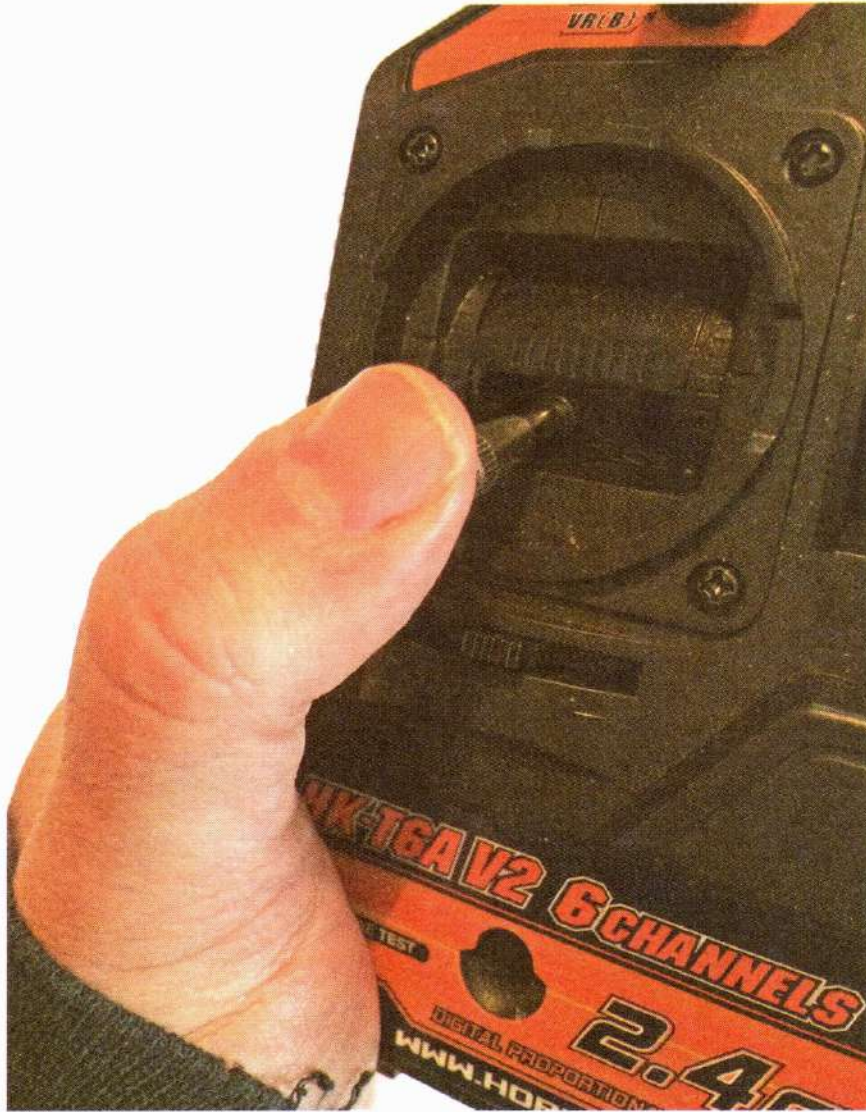
الشكل 6-8 استخدم مرسلك لتبرمج متحكمك الإلكتروني بالسرعة.
