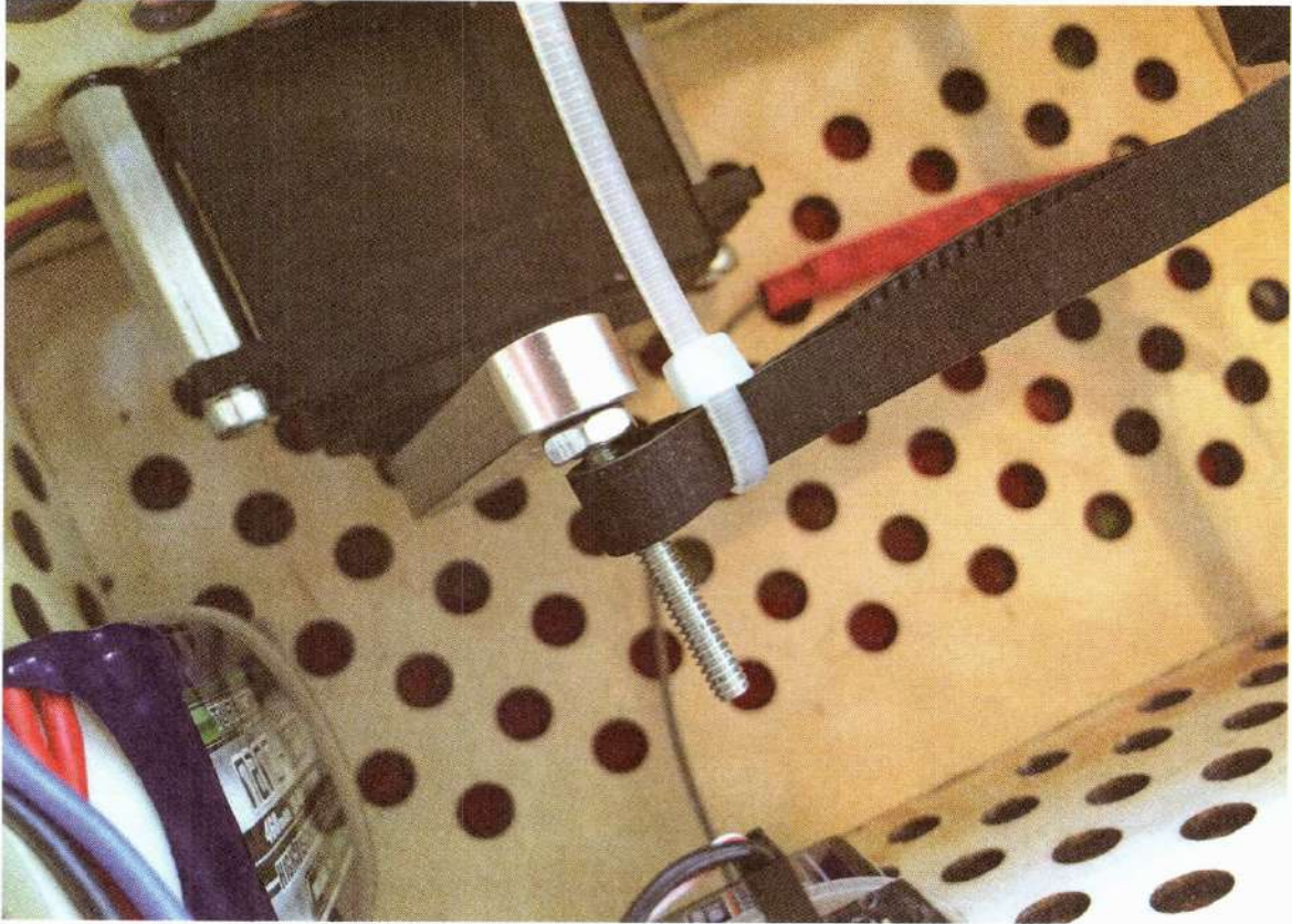
الشكل 7-17 استخدم ربطات بلاستيكية لتثبيت حزام التوقيت ببرغي #4 موصول بذراع المحرك المؤازر.
