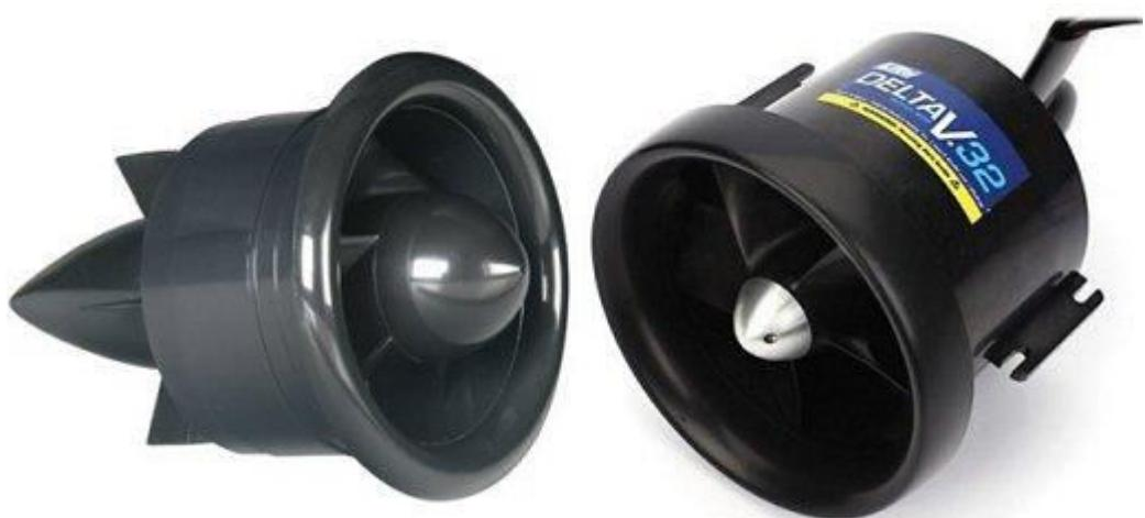
ال ducted fan هي وحدة تضم محركاً كهربائياً وشفرات مزدوجة داخلية يقوم المحرك في تحريك الشفرات بسرعة عالية وتقاس ب وحدة (RPM revs/minute) أثناء الدوران ، يقوم الدافع بسحب الهواء عبر واحد أو أكثر من مداخل الهواء المواجهة للأمام في ال jet ثم يندفع الهواء داخل أنبوب أسطواني ويخرج من الجزء الخلفي من الطائرة.
