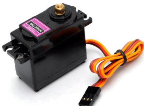
تستخدم محركات ال Servo في تطبيقات الروبوتات الصغيرة و الميكانيزمات التي تتطلب دقة في التحرير و ذلك لما تمتاز به هذه المحركات من عزوم قوية و سهولة و دقة في التحكم ولهذا تستخدم في التحكم بالاجنحة والذيل لاحتياجنا لعزم كبير ودقة .
