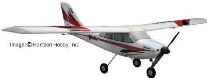
في الأساس ، يستخدم المتدرب من 3 قنوات لتعلم كيفية الطيران ( في البداية سوف يكون التحكم صعباً لأن الطائرة بشكل عام تطلب سرعة في التحكم وانتباه للتفاصيل ) . الجانب السلبي هو أنك لن تحصل على الكثير من المرح مع طائرة RC ثلاثة القنوات بمجرد أن تتقن الأساسيةات. الاستثناء من ذلك هو الطائرات التي تحكم في الجنيح بدلًا من الدفة - فهذه الطائرات هي للطائرات البهلوانية أكثر ، وأكثر متعةً للطيران عموماً. ولكن بصفة عامة ، سيكون لديك متوسط 3 قنوات من طراز RC يتحكم في الدفة ولا يتحكم في الجنيح كمتدرب حديث .
