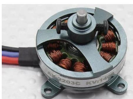
**الطاقة**. المحرك على اليسار هو 52 واط. من أجل إيجاد القوّة الكهربائية للمحرك ، اضرب أقصى تيار للمحرك بواسطة الجهد المطبق عليه. يسحب هذا المحرك 7 أمبير ويستخدم بطارية 2 خلية (7.4 فولت) حتى  $7 \times 7 = 7.4 \times 7 = 51.8$  W - ويقترح هذا المحرك لطائرة 275 غرام.
