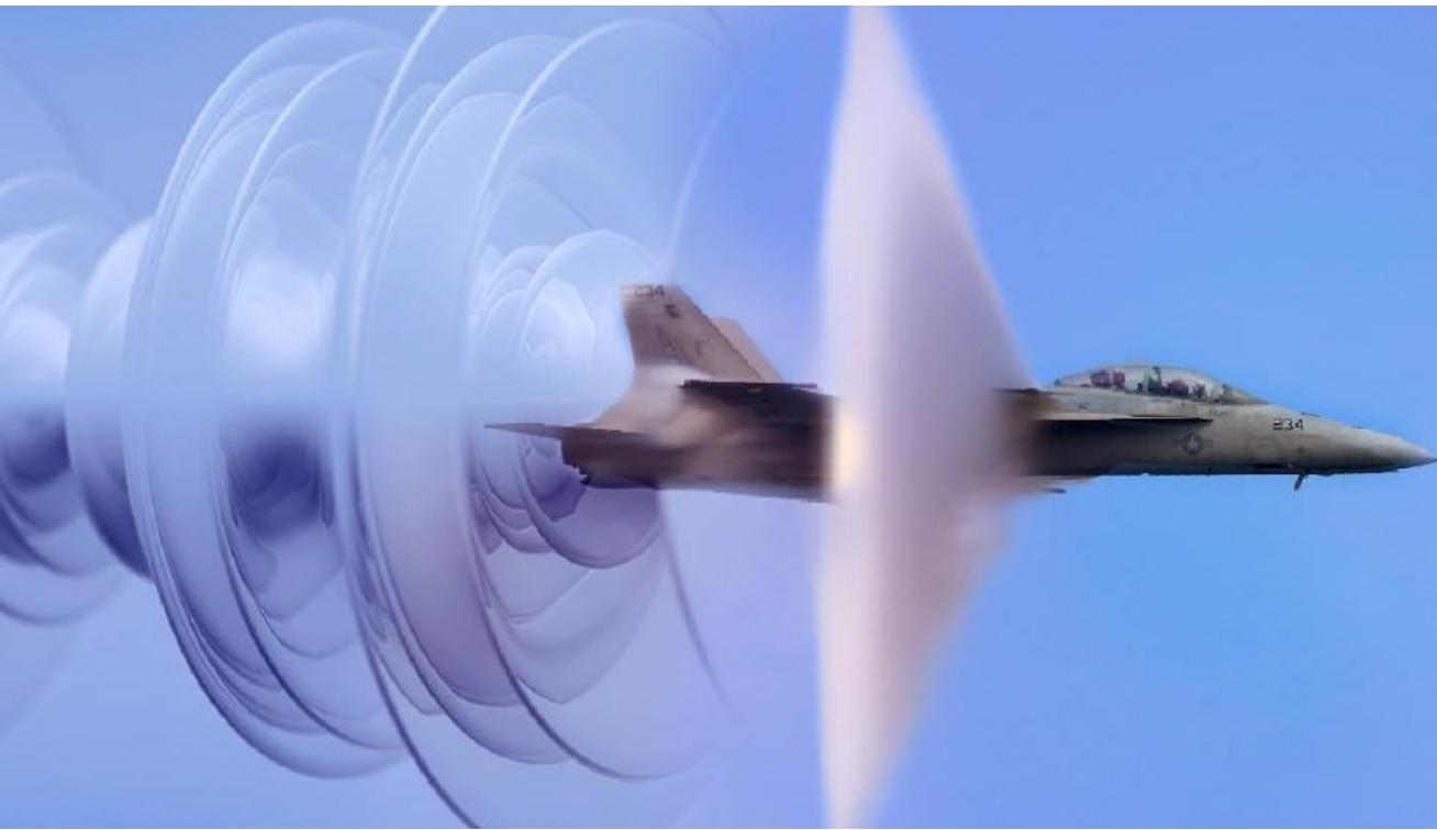
لفهم كيف ولماذا تتشكل الموجات الصدمية مع اقتراب الطائرة من السرعات الصوتية ، عليك أن تدرك أن الهواء مائع fluid وأنه قابل للانضغاط compressible ، في السرعات المنخفضة (أقل بشكل عام من Mach 0.5) ، يكون الهواء غير قابل للضغط بشكل أساسي والذي يسمح للعلماء والمهندسين بعمل عدد من الافتراضات التبسيطية عند نمذجة حركة الطائرة عبر الهواء. الافتراض الرئيسي عند نمذجة تدفق السائل بأنه غير قابل للضغط هو أن كثافة الأجزاء الصغيرة اللامنهائية لهذا السائل ثابتة .
