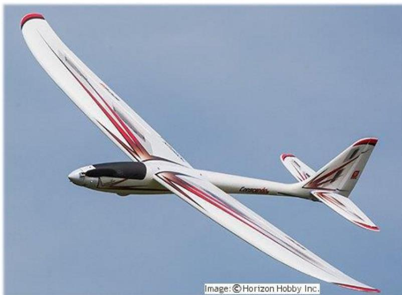
تتمتع الطائرات الشراعية RC التي تعمل بالكهرباء مثل هذا بالكثير من الثبات الكامن ، مما يتيح لك الكثير من الوقت للرد على مدخلات التحكم الخاصة بك. يجعل الحجم الأكبر (عادةً) من السهل رؤيته من مسافة بعيدة ، لكن بالطبع هذا الحجم الكبير ليس مناسباً لأغراض النقل.
