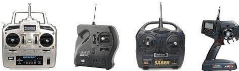
لأغراض هذا الكتاب ، سوف نركز على جهاز إرسال طائرة RC متعدد القنوات (4 أو أكثر) تقليدي لأن هذا هو النوع الذي ستستخدمه على الأرجح عندما تدخل الهواية ، سواء كانت .GHz أو MHz
