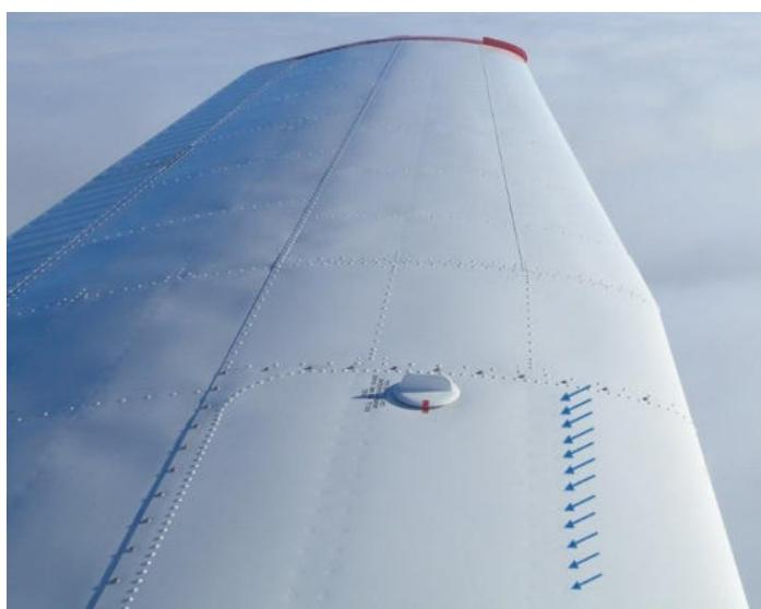
ومع ذلك من الصعب ان تكون الامور كما نريد تماما ، أي تدفق منتظم سيتحول بسرعة إلى امضراب - غالباً بعد انتقاله لعدة بوصات من الحافة الأمامية leading edge . الطبقة المضطربة أكثر سماكة من طبقة التدفق المنتظمة وتولد جرحاً أكثر ، يحدث معظم تقليل سرعة تدفق الهواء أعلى السطح مباشرة
