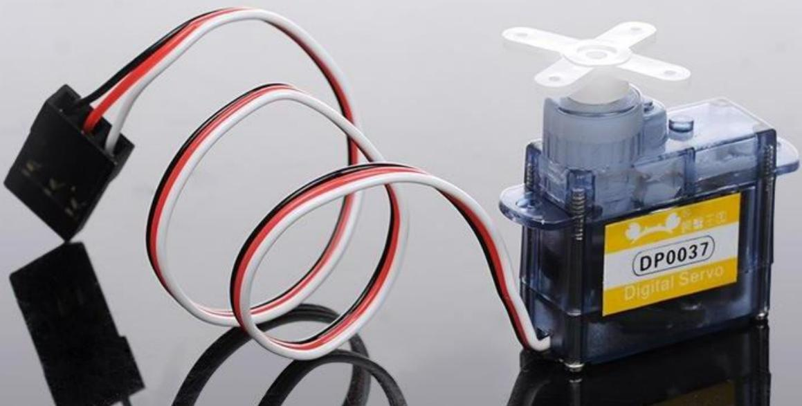
هي عبارة عن محركات تيار مستمر عادية DC مزودة بعلبة تروس ميكانيكية مدمجة تؤمن العزم العالي المطلوب (علبة تروس Gear و ناقل حركة Shaft يعطي الحركة عزماً أكبر و دقة كبيرة) للتحريك **بزاوية** معينة وتحتوي على دائرة كهربائية تؤمن للمحرك التغذية والتحكم الشكل اعلاه وادناه انواع لمحركات السيروف .
