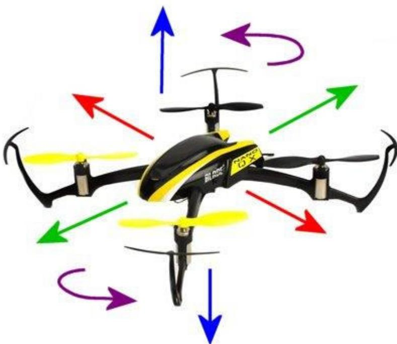
تقوم طائرة بدون طيار RC drones بتحركاتها نتيجة لاستجابة وحدة التحكم في الطيران الإلكترونية لمدخلات العصا. وبشكل أساسي جدًا ، يقوم جهاز التحكم في الرحلة بضبط سرعة المحركات المناسبة وفقًا لذلك ، وتؤدي التغييرات الناتجة في الاتجاه إلى تحريك الطائرة في الاتجاه المطلوب.
