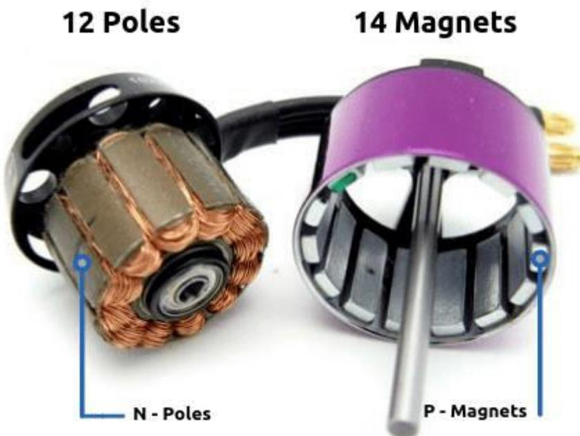
حيث يلعب المغناطيس الموجود في المحرك دوراً مهماً في تحديد مدى قوة المحرك ، سيكون للحركات الرخيصة مغناطيسات أضعف وتنتج قوة دفع أقل بالمقارنة مع محرك باهظ الثمن والذي سيكون به مغناطيسات أكثر قوة.
