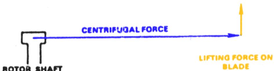
يتم إنتاج قوة الرفع العمودية عند رفع الشفرات لزاوية موجبة للهجوم. القوة الأفقية ناتجة عن قوة الطرد المركزي بسبب الدوران.
