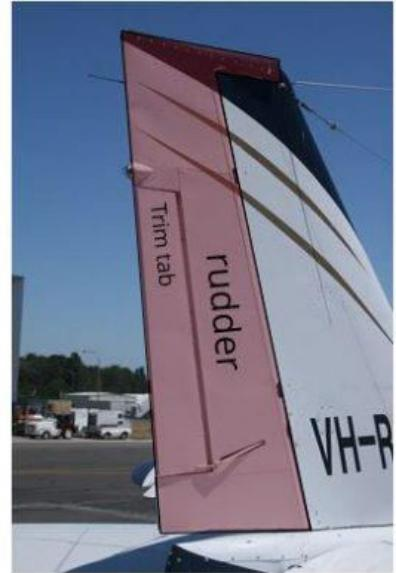
المصعد elevator والدفة rudder كلاهما من الأسطح المتحركة المثبتة على الحافة الخلفية للمثبت الأفقي والرأسي على التوالي. يؤدي انحراف سطح التحكم إلى تعديل حدة السطح التي تحدث قوة طبيعية لاتجاه الطائرة ، وتدور الطائرة حول مركز الثقل إما pitch (elevator) أو yaw (rudder)
