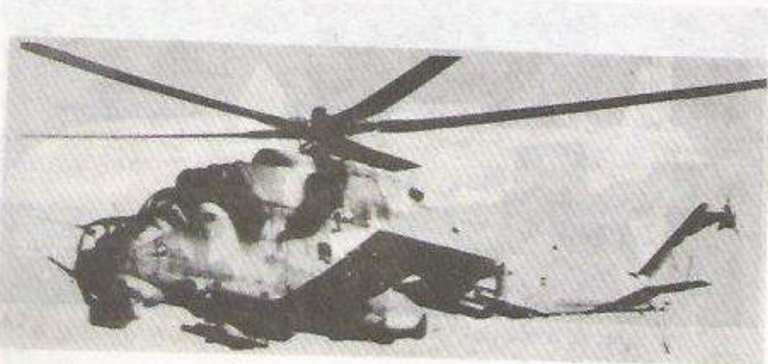
طائرة سوفيتية الصنع طراز Mi-24 واسمها الشائع هو هند Hind . وتحمل الطائرة 8 صاروخ مضاد للدبابات طراز AT-6 ، مداه 5 كيلومتر
