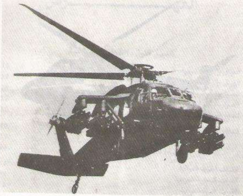
طائرة هيليكوبتر أمريكية طراز UH-60A . واسمها الشائع هو الصقر الأسود Black Hawk وتحمل 16 صاروخ مضاد للدبابات من طراز Hellfire (AGM-114) . ومدى الصاروخ 8 كيلومتر
